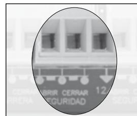
**Si no instala ningún accesorio, se deben puentear los bornes.**
