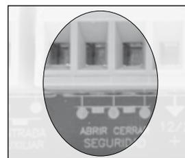
*Si no instala ningún accesorio, debe puentear los bornes.*
