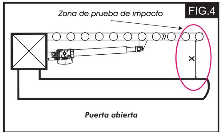
Si los valores de empuje no correspondieran a los valores especificados por la norma UNI EN 12453, es OBLIGATORIO que proteja la zona marcada en la (Fig.4) con un dispositivo de protección conforme con la norma UNI EN 12978.
