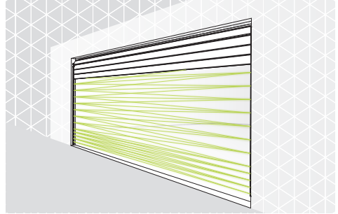
Figure 4: Portes souples rapides avec effacement des faisceaux
